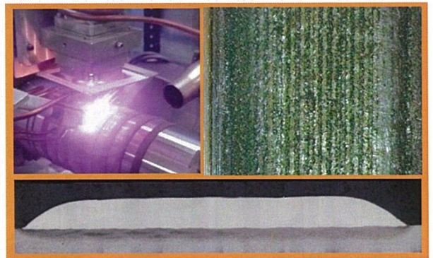
フレキシブルプロファイルレーザシステムによる クラッディング
