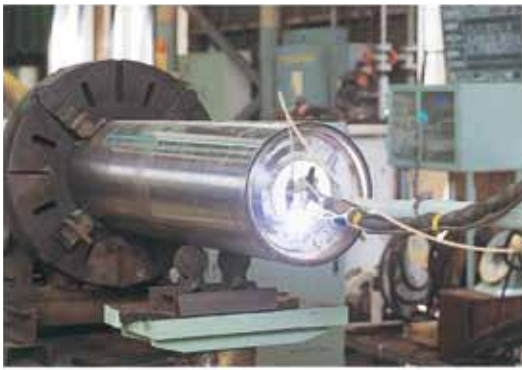
小口径内面自動溶接装置(TIG溶接機)
