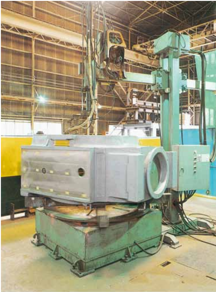
垂直自動溶接装置(MIG溶接機)
