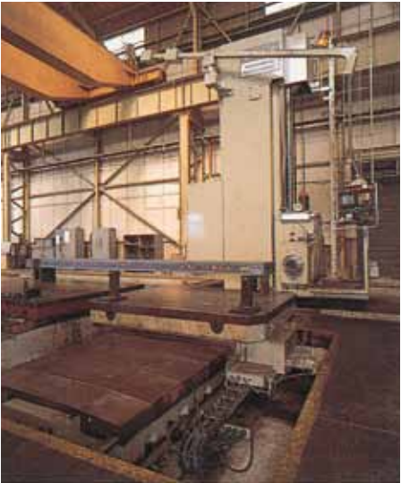
NCボーリング
