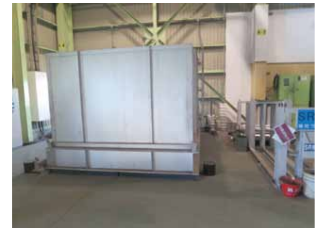
トップハット式電気炉
