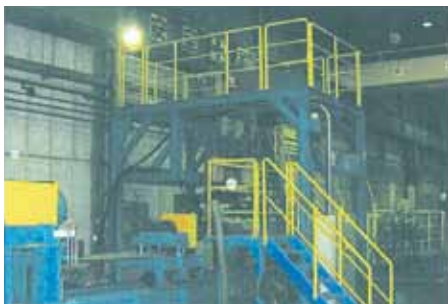
多電極サブマージアーク自動溶接装置
