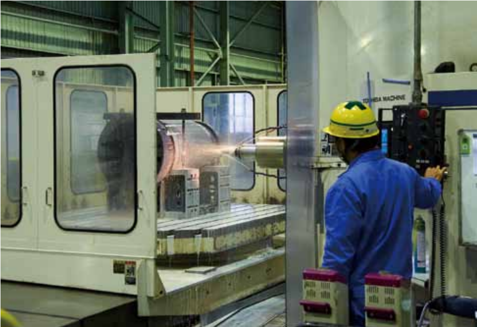
NCボーリング
