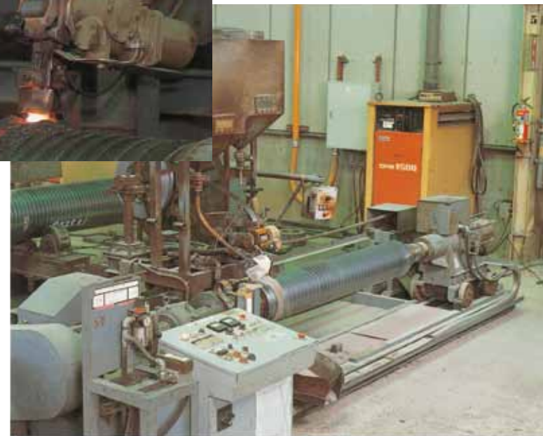
自動溶接装置(バンド溶接機)
