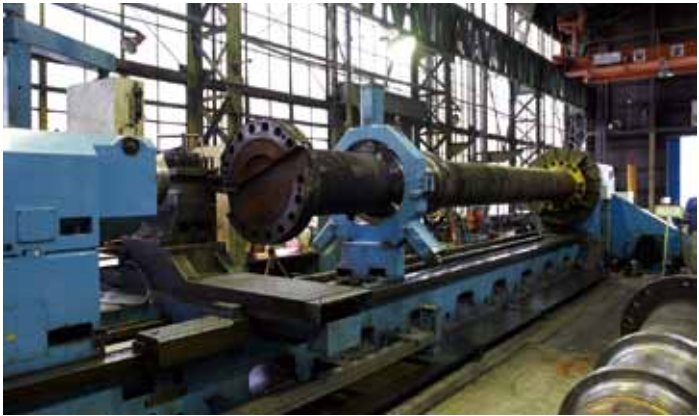
大日金属製大型NC旋盤
