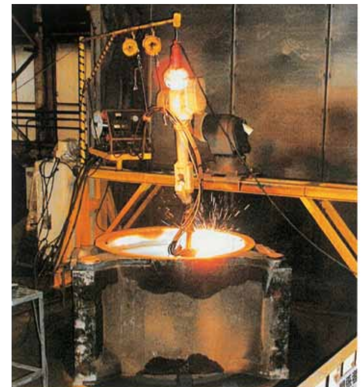
内径用アーク溶線式溶射装置
