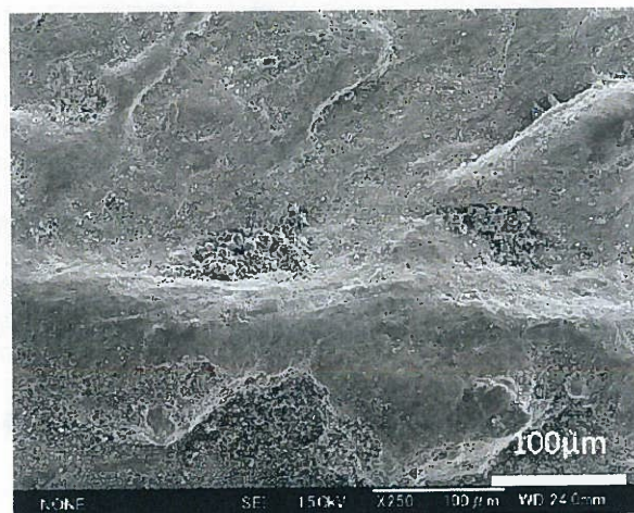
写真2 ボイラ蒸発管損傷箇所の表面SEM観察
