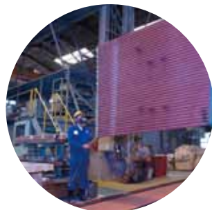
锅炉面板的喷镀
